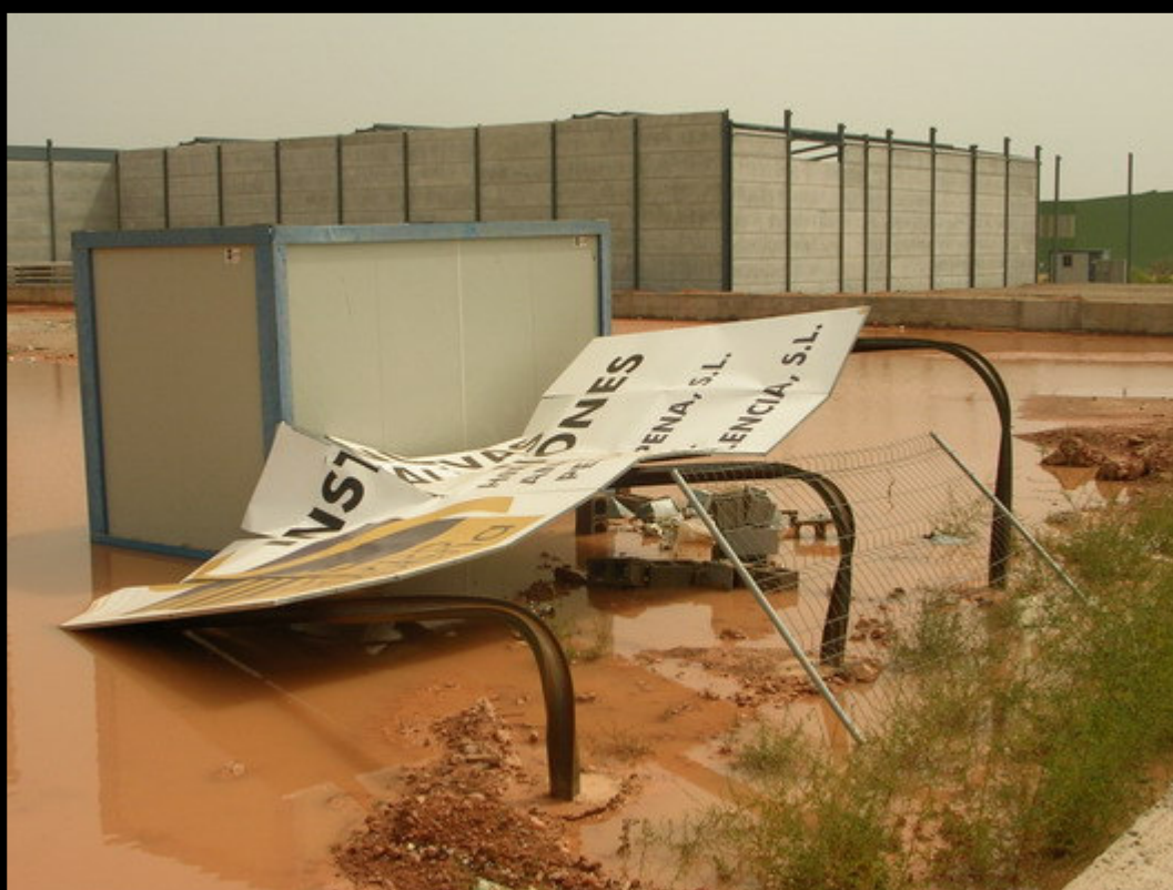
Foto 22 – Los anclajes de este cartel, completamente doblados, a pesar de ser bastante sólidos.
